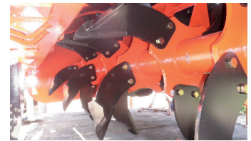
Anbauvorrichtung mit Scherbolzen
