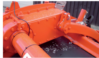
Zwischenantrieb für schmale Transportbreite
