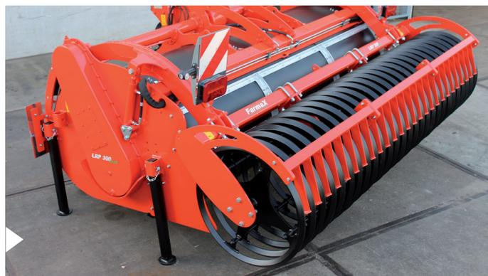
Die Spatenmaschine kann standardmäßig mit einer angetriebenen Kreiselegge, einer angetriebenen Fräse oder einer synchronisierten Packerwalze ausgestattet werden. Auf diese Weise schafft die LRP Profi eine optimale Fläche für die Aussaat oder Bepflanzung auf allen Bodenarten! Darüber hinaus kann die LRP Profi mithilfe angebrachter Befestigungspunkte oder einem Aufbauhilt mit einer Sämaschine kombiniert werden.
