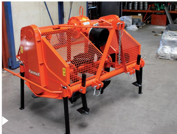
**Antrieb der Hauptachse (Rotor):** Kettenradübertragung an beiden Seiten der Maschine. Diese werden durch das Getriebegehäuse mit Differential angetrieben.
